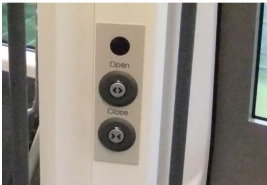
Hình B.4 - Ví dụ về bảng điều khiển cửa có nút nhấn xúc giác
